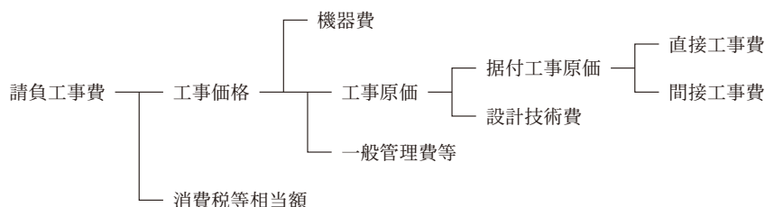
図 電気設備工事費の積算体系図
